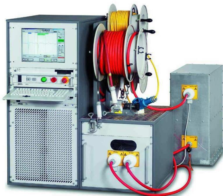
**Система тестирования и диагностики кабелей на очень низких частотах PHG TD/PD**
